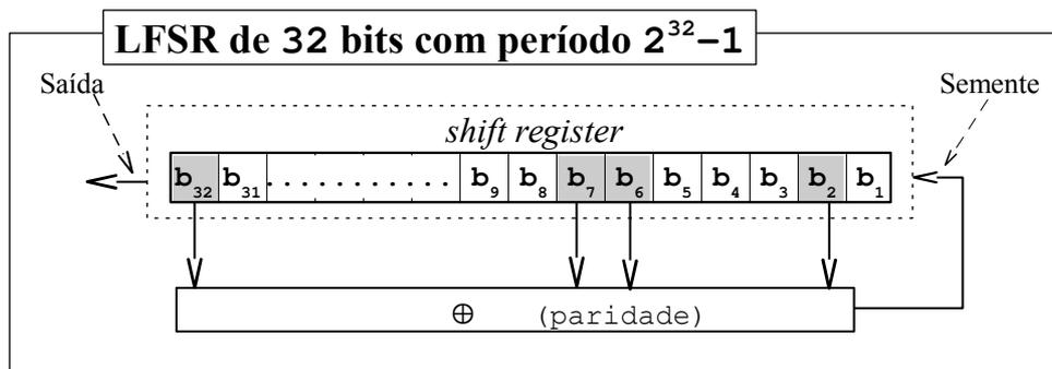
Percorrerá a órbita máxima a partir de qualquer semente não nula. Com reenumeração dos bits (a partir de 0 em C), o LFSR será implementável em loop com
